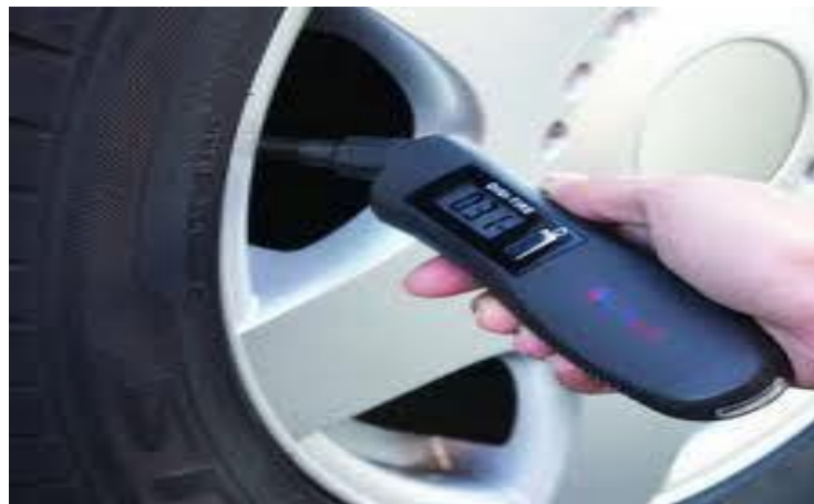
Gambar 2. Pengukuran Tekanan Ban
