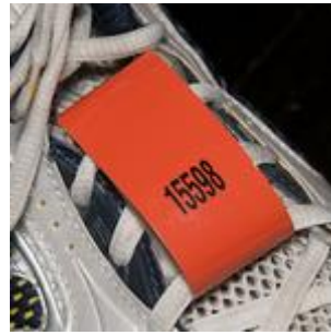
Gambar 3. RFID untuk deteksi pelari di garis finish
