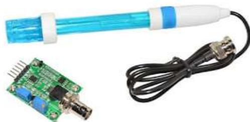
Gambar 3. Modul Sensor pH 4502C
