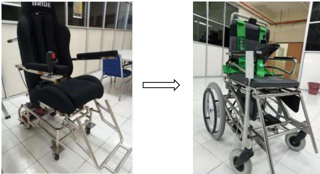
Gambar 2. Modifikasi kursi roda elektrik dengan penambahan adjuster
