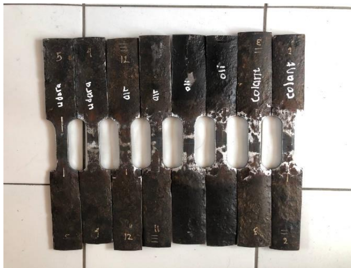
Gambar 2. Bentuk specimen ASTM E8
