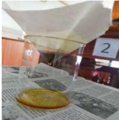
Gambar 10. Penyaringan Ekstraksi Maserasi
