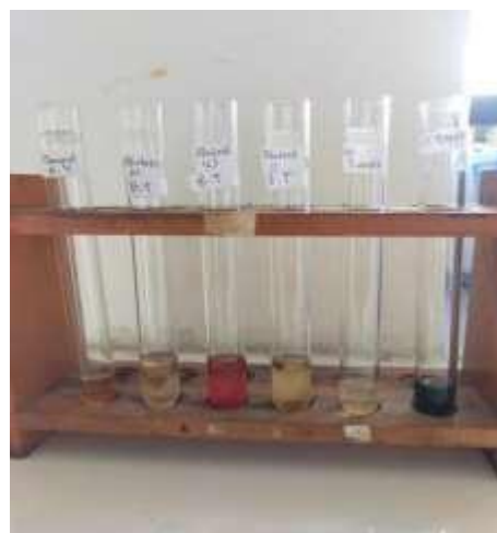
Gambar 18. Hasil Uji Fitokimia (Uji Alkaloid, Fenolik, Tanin)
