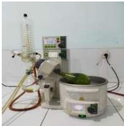
Gambar 12. Proses Evaporasi Ekstrak Etanol Kulit Batang Turi Putih
