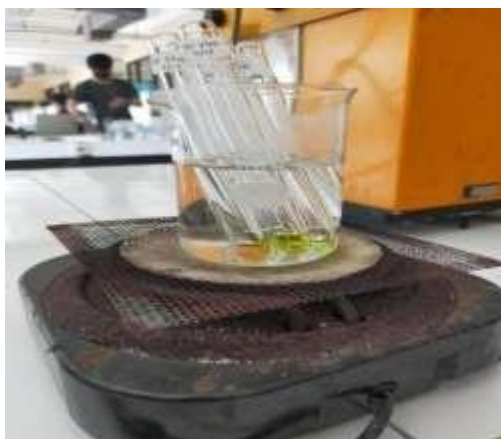
Gambar 16. Proses pemanasan pada penangas air (uji flavonoid, uji saponin, uji steroid, uji tanin)
