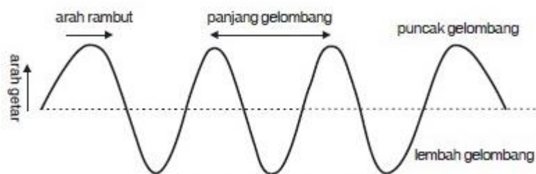
Gambar 2.2 gelombang transversal pada tali Sumber : fisikazone.com
