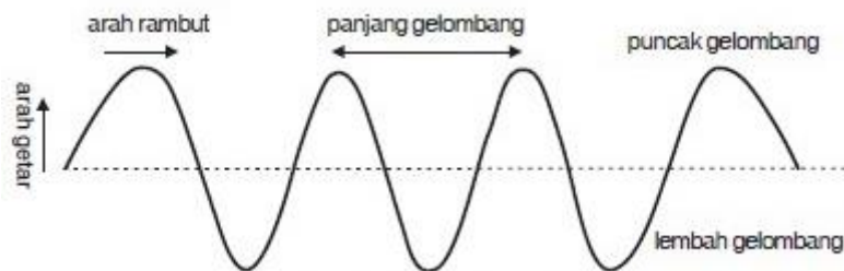
Gambar 2.2 gelombang transversal pada tali Sumber : fisikazone.com
