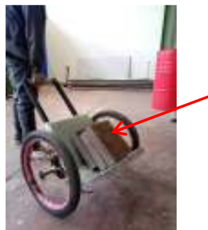
Gambar 4 Titik Pembebanan Pada Troli
