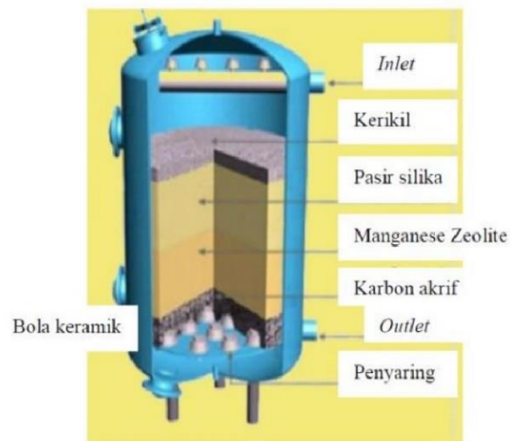
Gambar 2.2 Skema Susunan Mterial/Bahan Penyaring
