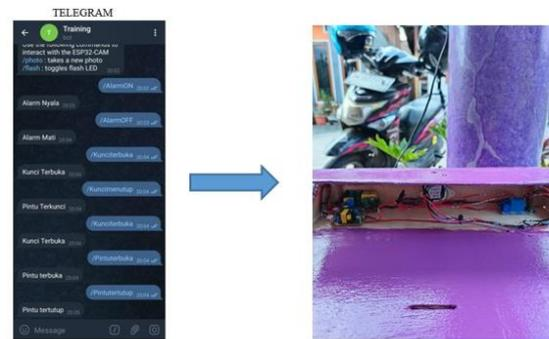
Gambar 7. Pengujian perintah chatbot ke input dan ouput alat
