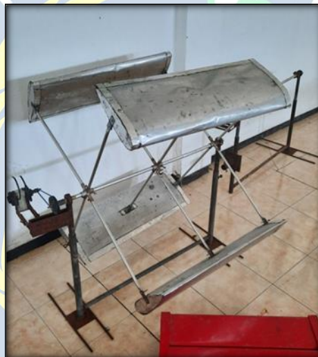
Gambar 4.1 Alat wind Turbin Menggunakan Naca Blade 0021
