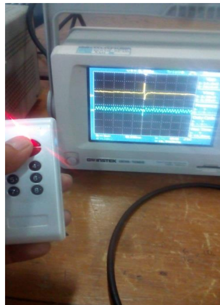
Gambar 4. 1 Hasil pengujian Osciloskop terhadap kendali RF dan receiver
