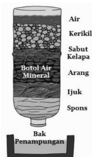
Gambar 2.11 Alat Penyaring Air Sederhana Sumber: mimbaruntan.com
