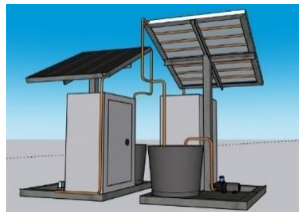
Gambar 3 Desain prototipe 3D tata letak pendingin pipa tembaga pada panel surya
