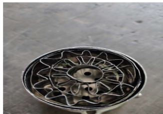
Gambar 4. Hasil pembuatan casing luar katalis berbahan stainless steel
