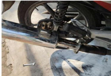
Gambar 6. Pemasangan Catalic Converter pada knalpot
