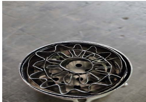
Gambar 5. Hasil pembuatan bagian katalis berbentuk sarang lebah
