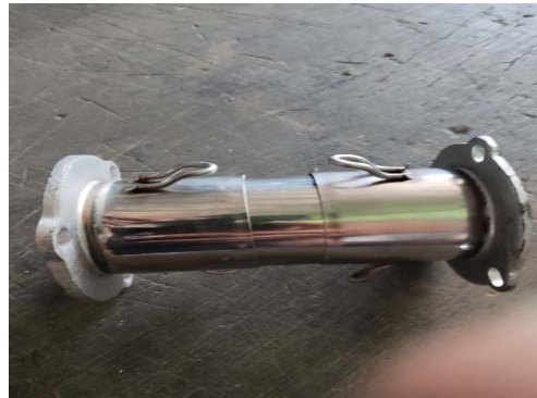
Gambar 4. Hasil pembuatan casing luar katalis berbahan stainless steel
