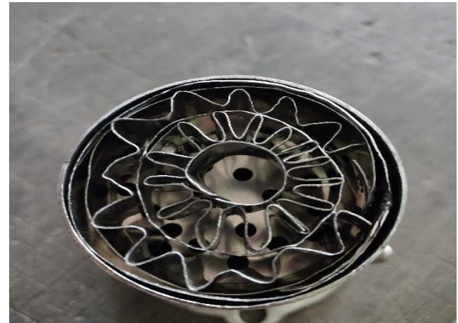
Hasil pembuatan katalis stainless steel berbentuk sarang lebah
