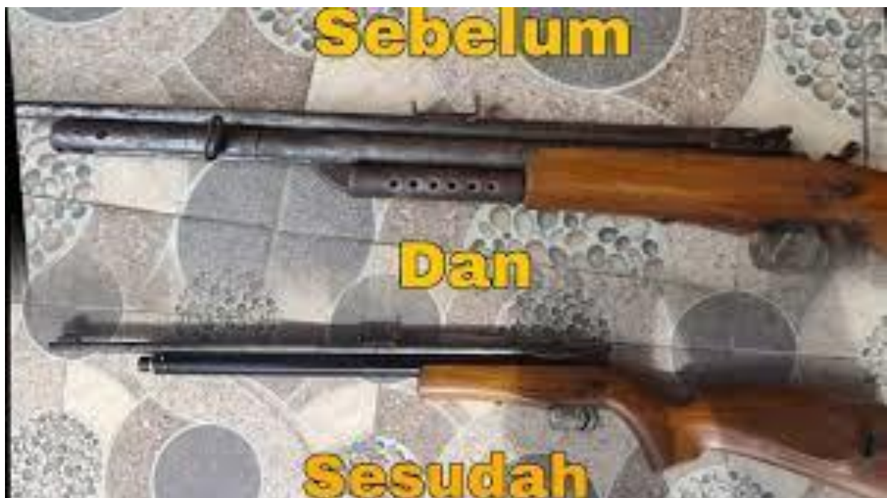
Gambar1. Senapan Uklik yang dimodifikasi menjadi senapan PCP
