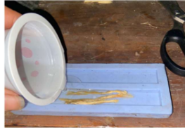
Gambar 8. Proses Penuangan Resin yang Sudah Diberikan Serat kedalam Cetakan Silicon
