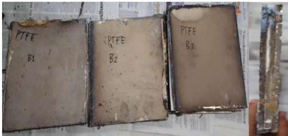
Gambar 17. ACP Material ini PTFE/Teflon Sesudah Uji Ketahanan. [14]
