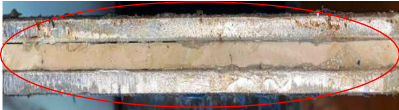
Gambar 3.1 Material ACP yang telah jadi
