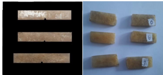
Gambar 3. Spesimen Uji impact sebelum dan sesudah diuji
