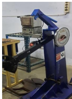
Gambar 1. Alat Uji Impact dan Dimensi Specimen Uji Impact
