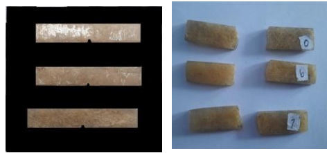
Gambar 3. Spesimen Uji impact sebelum dan sesudah diuji
