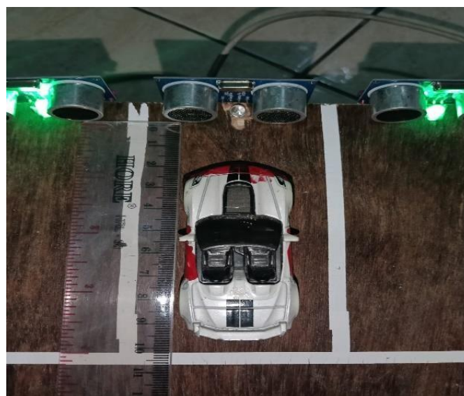
Gambar 5. Pengujian Sensor Ultrasonik HC-SR04 dengan Mistar
