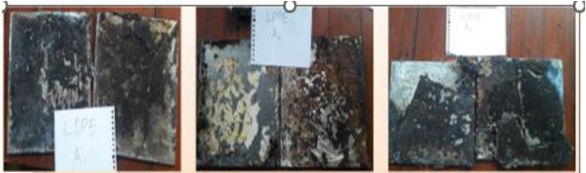
Gambar 3.3 ACP dengan material inti LDPE yang leleh dan menguap habis saat uji suhu tinggi
