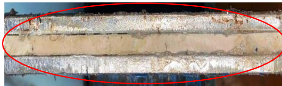
Gambar 3.1 Material ACP yang telah jadi dengan material inti LDPE
