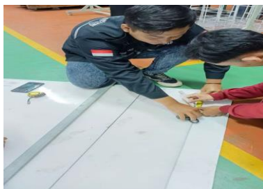
Gambar 2.4 Fabrikasi pengukuran dan pemotongan material LDPE
