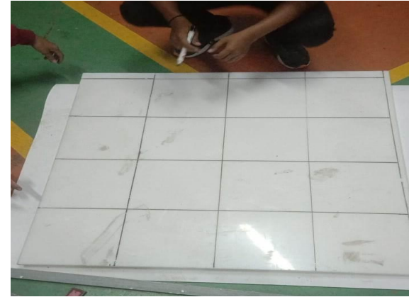
Gambar 2.4 Fabrikasi pengukuran dan pemotongan material LDPE
