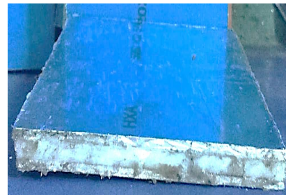
Gambar 2.7 Material ACP dengan material inti adalah LDPE (a) ACP dilihat dari atas (b) ACP dilihat dari samping (c) ACP yang telah jadi
