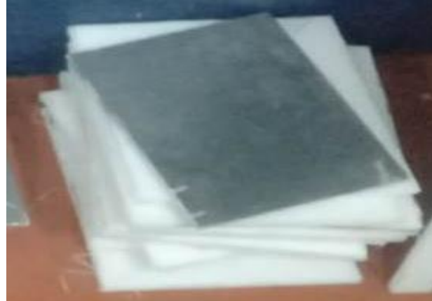
Gambar 2.5 Hasil potongan aluminium 5052 dan LDPE
