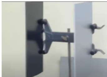
Gambar 2.9 Plat ACP di jepit untuk uji ketahanan api
