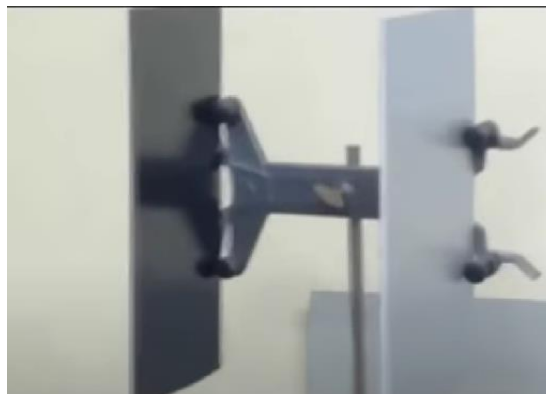
Gambar 10 Plat ACP di jepit untuk uji ketahanan api
