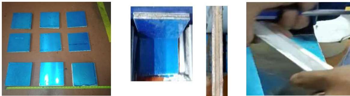
(A) (B) (C) Gambar 7 (A) Sampel APC dengan material inti PEEK yang telah jadi (B) Dilihat dari atas (C) APC dengan material inti PEEK lengket dengan baik
