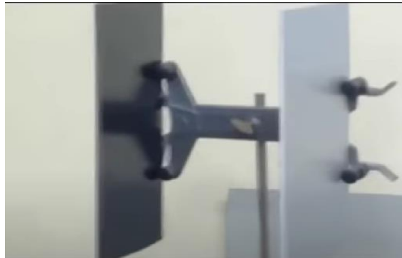
Gambar 2.9 Plat ACP di jepit untuk uji ketahanan api
