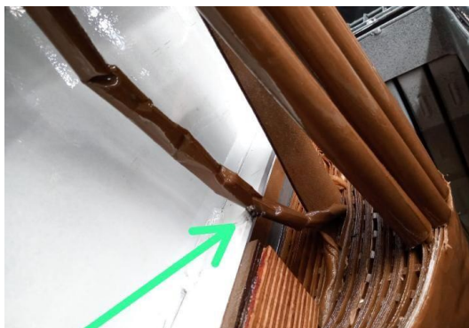
Gambar 4. Kondisi Kerusakan Kertas Isolasi
