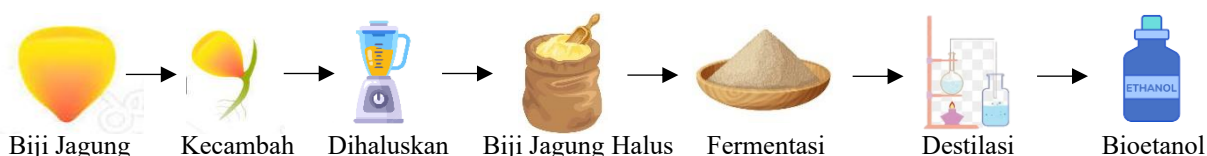
Gambar 1. Skema Distilasi Bioetanol Dari Biji Jagung
