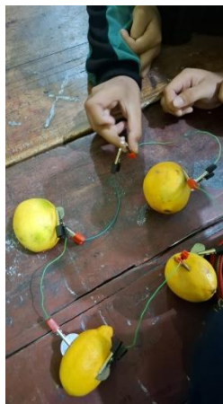
Gambar. 2 Hasil percobaan membuat sumber energi listrik alternatif dari buah
