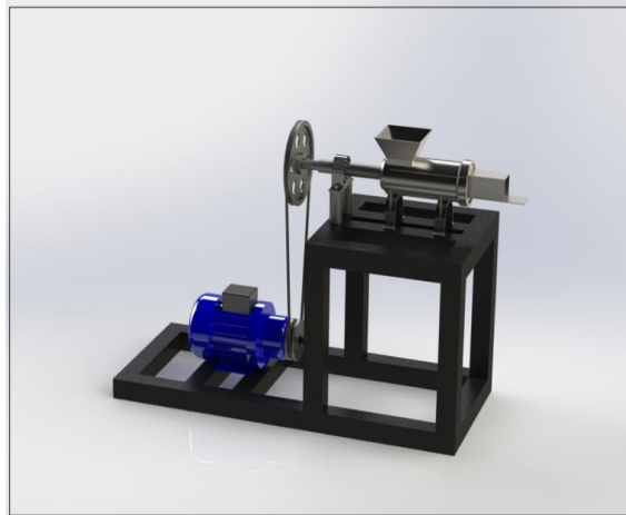
Gambar 9. Desain Mesin Pencetak Arang Briket
