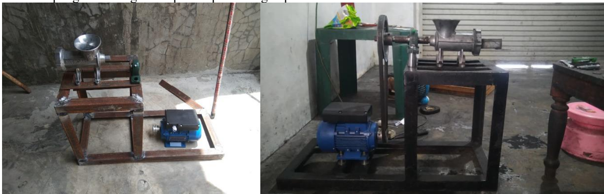
Gambar 8. Pemasangan Screw , Barrel , dan Motor
