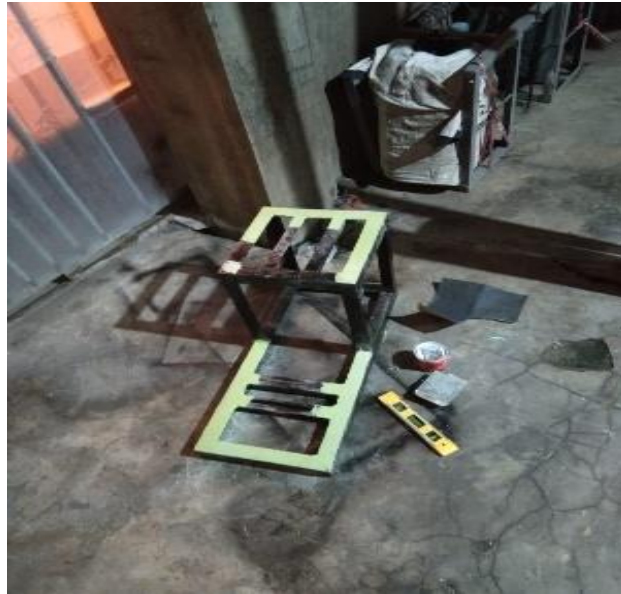
Gambar 7. Pendempulan Rangka Mesin
