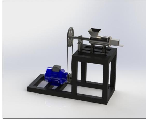
Mesin cetak arang briket adalah sebuah perangkat mekanis yang dirancang untuk membentuk dan mencetak arang menjadi briket dengan ukuran dan bentuk yang seragam. Mesin ini dapat meningkatkan efisiensi produksi arang briket dan mengurangi biaya produksi.
