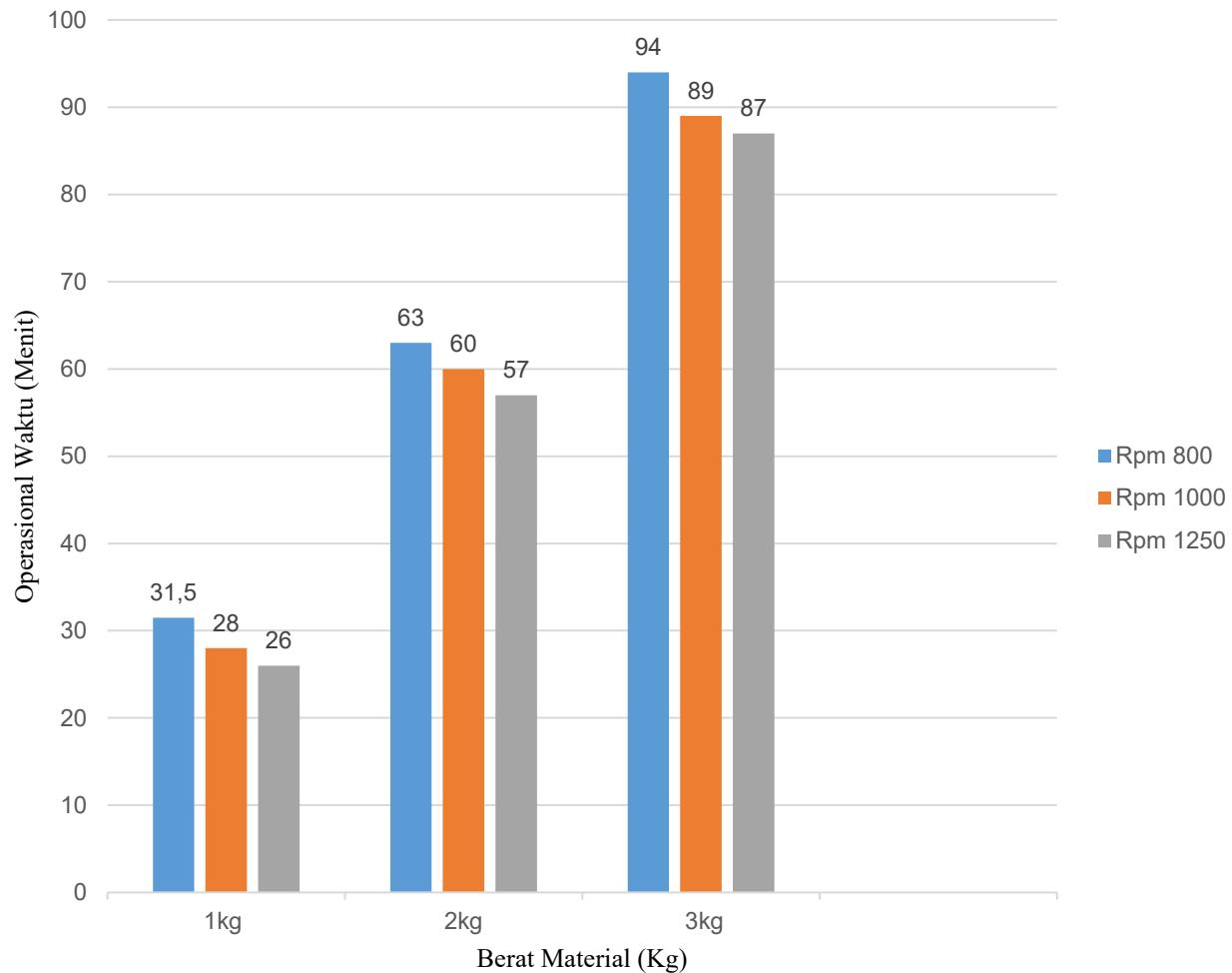
800 memiliki kelebihan memperlihatkan waktu operasional yang paling rendah dibandingkan Rpm lainnya, yang jelas mempermudah proses jika diperlukan waktu singkat. Serta kekurangan pada tidak efektif untuk material yang lebih berat. Waktu operasional meningkat secara signifikan dengan berat yang bertambah, menunjukkan efisiensi yang rendah
