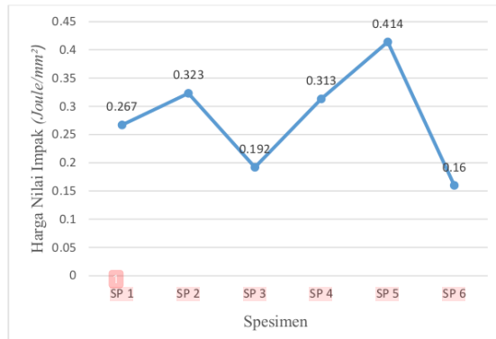
Gambar 15. Grafik Hasil Perhitungan Nilai Rata-Rata Harga Impact
