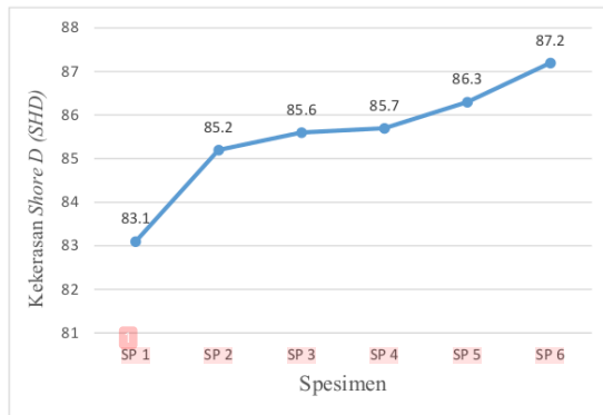
Gambar 16. Grafik Hasil Rata-rata Uji Kekerasan Shore D
