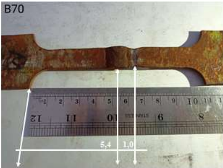
Gambar 4 12 Spesimen uji tarik tidak di anealing arus 70 Ampere
