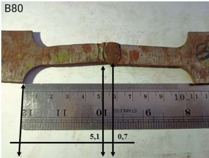
Gambar 4 14 Spesimen uji tarik tidak di anealing arus 80 Ampere
