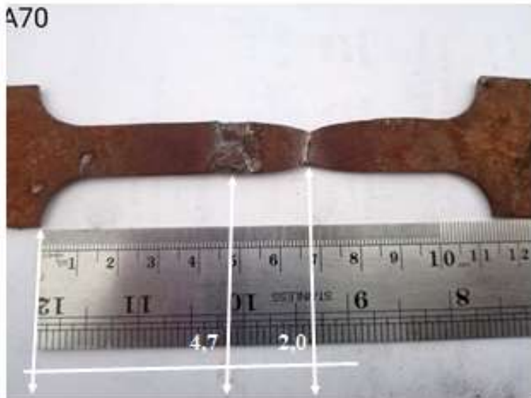
Gambar 4 6 Spesimen uji tarik anealing arus 70 Ampere
