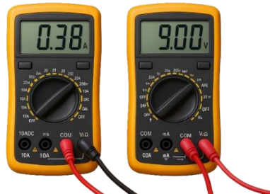
Gambar 6. Pengukuran Tegangan dan Arus pada L298N H-bridge Motor
