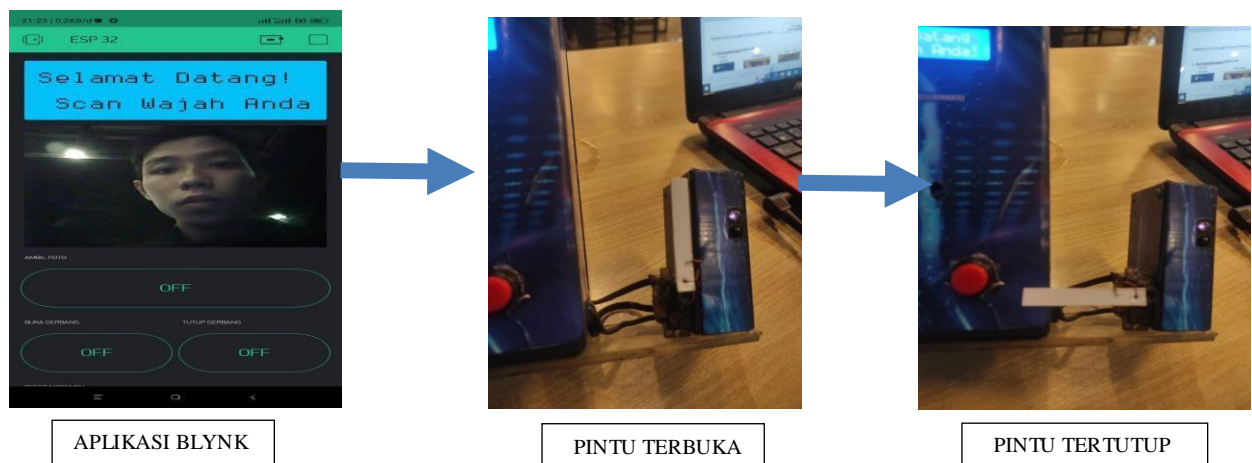
Gambar 4 Pengujian kamera ESP32 CAM pada alat
