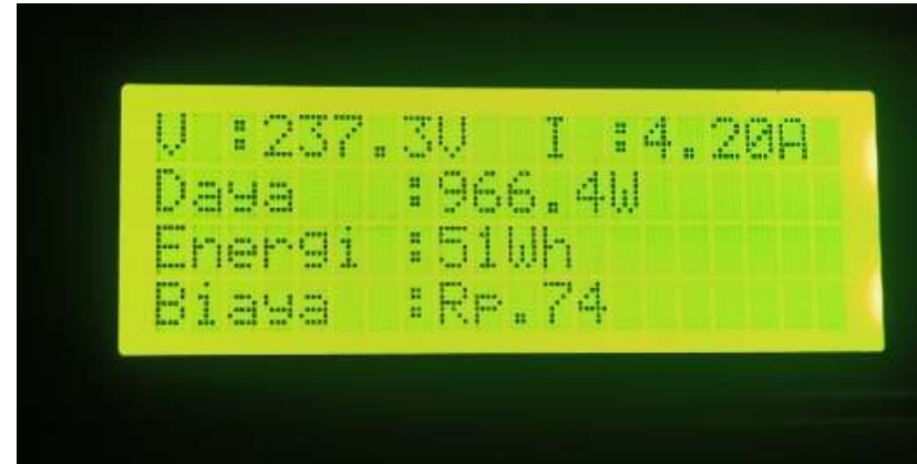
Hasil Tampilan pada LCD I2C 20x4
