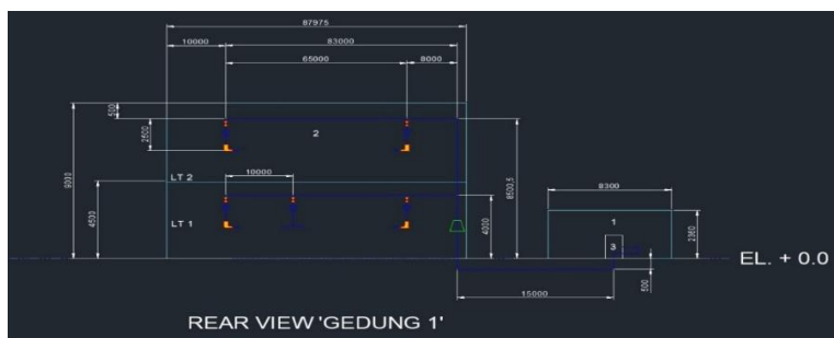
Gambar 2 Ukuran Instalasi pipa PPR
