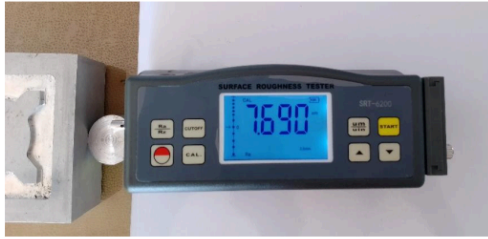
Gambar 8. Pengujian Kekasaran Spesimen 1
