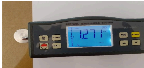
Gambar 13. Pengujian Kekasaran Spesimen 6
