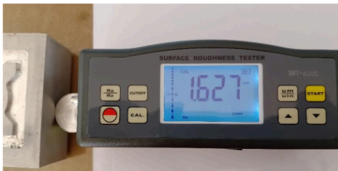
Gambar 10. Pengujian Kekasaran Spesimen 3
