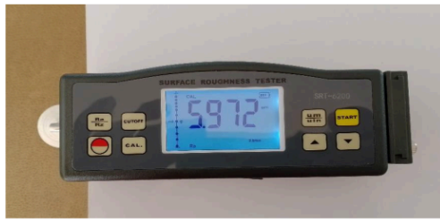
Gambar 11. Pengujian Kekasaran Spesimen 4
