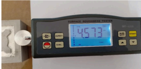
Gambar 9. Pengujian Kekasaran Spesimen 2
