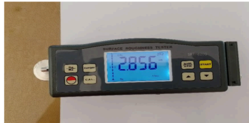
Gambar 12. Pengujian Kekasaran Spesimen 5
