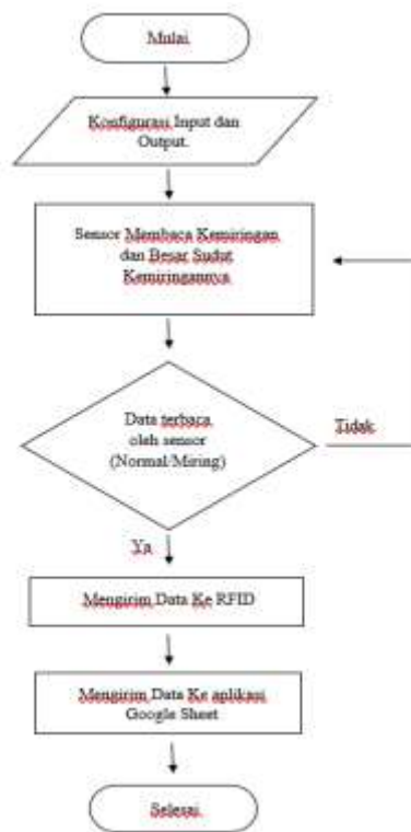
Gambar 2. Flowchart Sistem Kerja Alat Monitoring Kemiringan Lantai Berbasis Google Sheets
