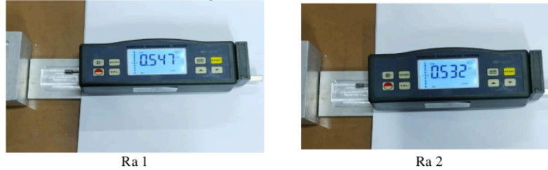
Gambar 15. Pengujian Kekasaran Spesimen K6
