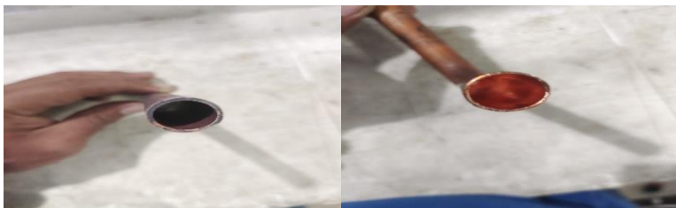
Gambar 4. 2 Visual Dalam Material Cu DHP-R250
