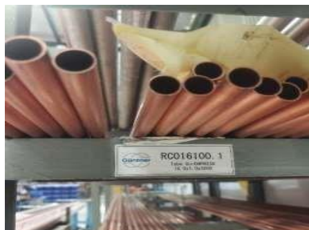
Gambar 2. 3 Material pipa Cu DHP-R250
