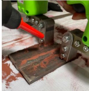
Gambar 4. Proses Uji Partikel Magnetik
