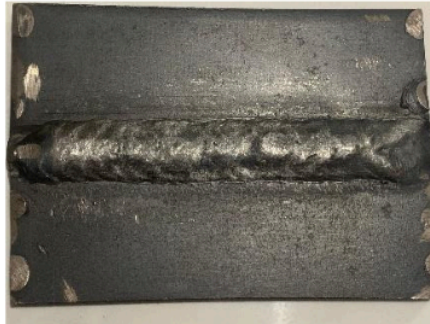
Gambar 11. Hasil Pengujian Makrostruktur Terbaik
