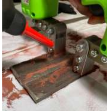
Gambar 4. Proses Uji Partikel Magnetik
