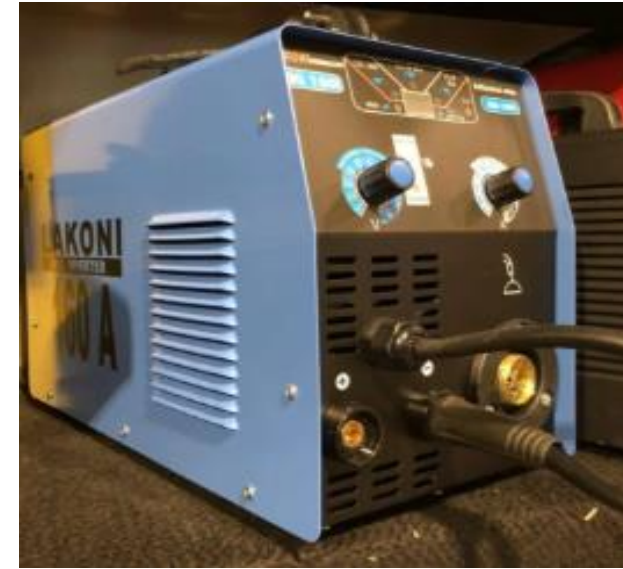
Gambar 2. Mesin Las MIG merk LAKONI TIPE MIG 160i
