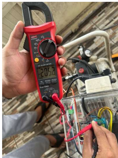
Gambar 8. Pengujian Tegangan Kompresor
