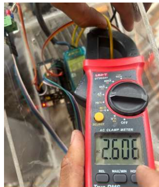
Gambar 9. Pengujian Arus Kompresor
