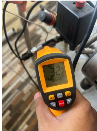
Gambar 6. Pengujian Suhu Kompresor
