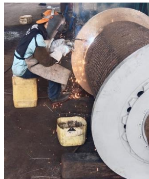
Gambar 2. Proses pengelasan MIG oleh operator
