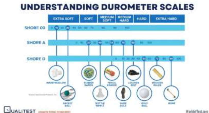
Gambar 6. Skala Uji Durometer
