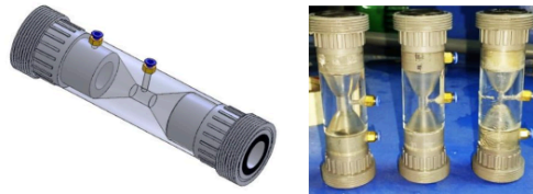
Gambar 1. Desain Tabung Akrilik dan hasil pembuatan
